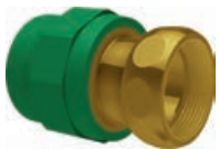
BR PP-RCT-RG/LFB A-Verschraubung IG-zyl für Armaturen + Wasserzähler mit Flachdichtung-EPDM grün
